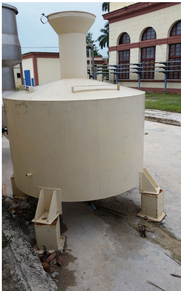
Recipiente metálico patrón 2500 L clase de exactitud 0,1 %
