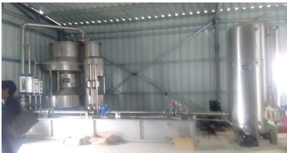
Fig. 1 Banco de calibración con recipientes patrones de capacidad 100 L, 1000 L y 2000 L
