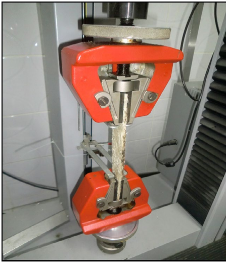
Figura 3.- Ensayo de tracción realizado al material compuesto reforzado con fibras de henequén unidireccionales
