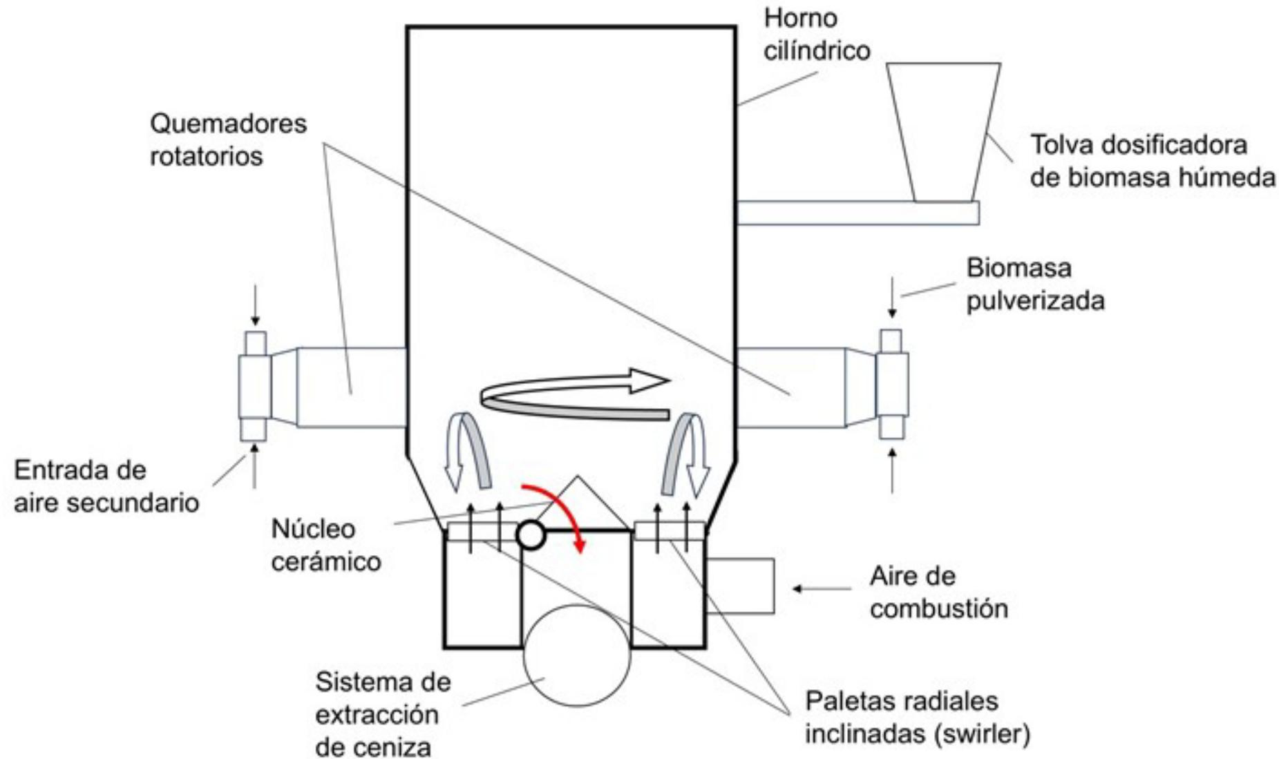
Vista superior del equipo y la forma de instalación de los quemadores rotatorios en fuego tangencial en un horno de sección cilíndrica. Fuente: Patente CU2023000050
