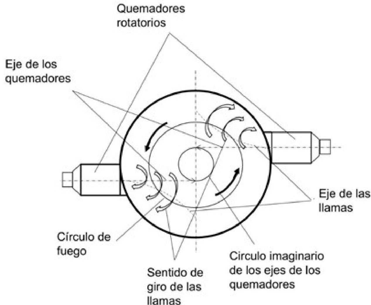
Vista superior de un horno de sección prismática y la forma de instalación de los quemadores rotatorios en fuego tangencial.
