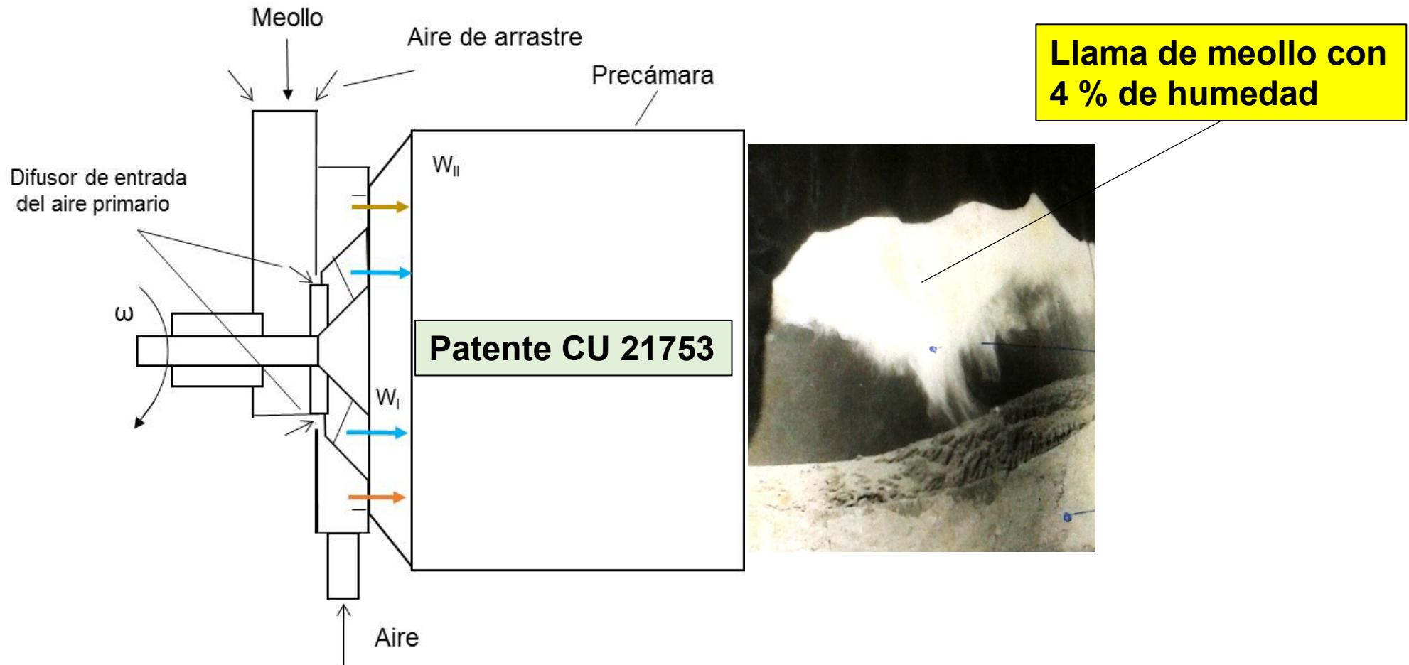
Exceso de aire entre 1,10 % y 1,16 % (De 2 % a 3 % en vol. de O<sub>2</sub>)
